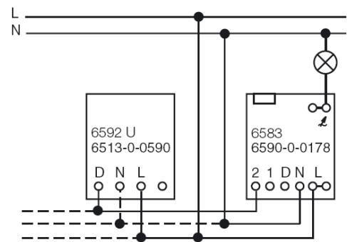
Přístroje 6592 U je možno zapojovat paralelně, avšak max. 5 kusů. Vodič N je třeba připojit pouze v případě použití orientační douthavky.
