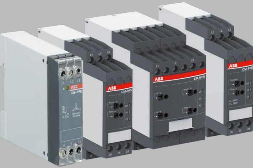
Pro monitorování napětí v třífázové soustavě nebo síti obsahuje řada CM od společnosti ABB široký výběr výkonných a kompaktních zařízení. Tato řada výrobků zahrnuje monitorovací napěťové relé pro sledování sledu fází, ztráty fází, nesymetrie a monitorování nadpětí a podpětí od 160 V do 820 V.
