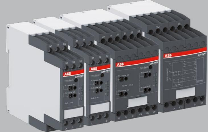
Relé pro hlídání izolace řady CM-IWx zaručují nepřetržitou kontrolu izolace IT systému. Zařízení rozpoznávají poruchy izolace v okamžiku jejich vzniku a varují před nimi, pokud hodnota klesne pod minimální nastavenou hranici. Tím je zajištěna spolehlivost provozu systému a zabraňuje přerušení provozu způsobenému druhou, závažnější, poruchou izolace, která může vést ke zkratu a vypnutí hlavního jističe.
