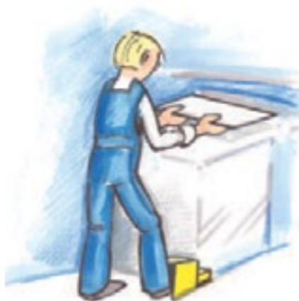
Bezpečnostní nohou ovládaný spínač s třípolohovou funkcí
