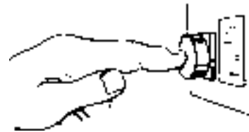
Resetovací tlačítko se světelnou indikací
