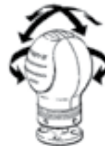
Upevnění na kuličkovém kloubu, kterým je možno otáčet a nastavovat jeho úhel náklonu.
