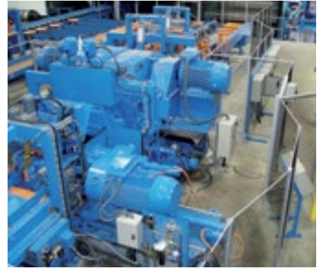
Quick-Guard E s několika dalšími komponentami a možností snadného vybočení do úhlu až 45°
